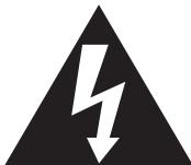
Le symbole de l'éclair avec une tête en flèche encadré par un triangle équilatéral attire l'attention de l'utilisateur sur la présence d'un "voltage dangereux" non isolé à l'intérieur de l'appareil ayant une magnitude suffisante pour causer un risque de choc électrique à l'homme.
